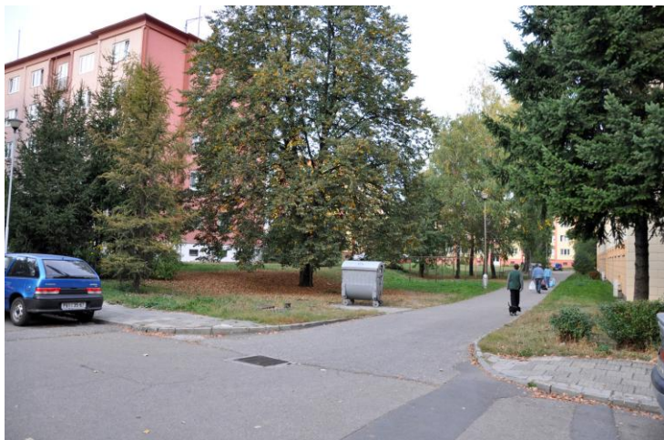
Neorganizované parkování, absence přechodů pro chodce, umístění zvýšeného chodníkového přejezdu, neoddělený kontejner
