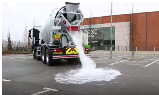
Porézní beton je schopný pojmout až 600 l vody za minutu (zdroj: www.e15.cz )
